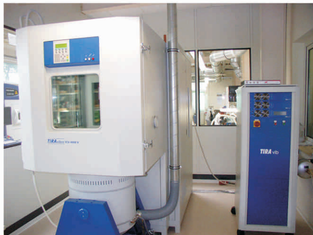
Abb.: Vibrations- und Klimatestanlage TIRAvibro
